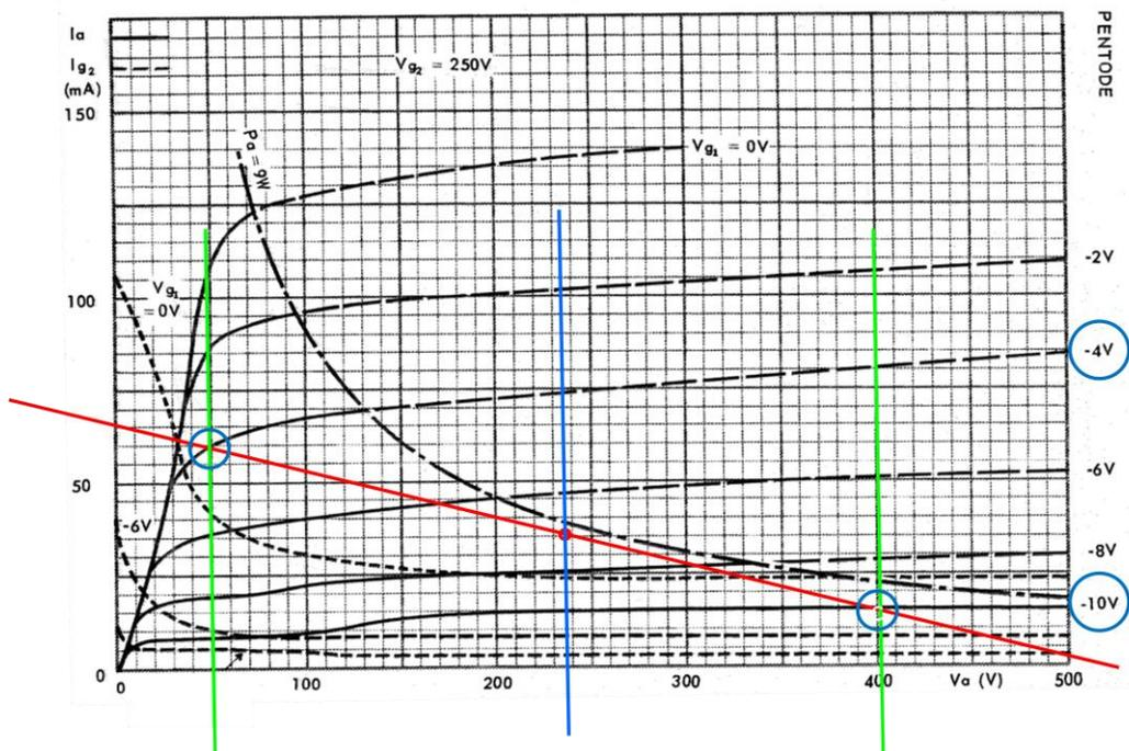
Nous voyons que pour une variation de tension grille entre -4 et -10V, nous avons une variation de tension plaque de 50 à 400V. C'est une approximation qu'il faudrait affiner, notamment la distorsion induite par la différence entre 245V au repos et point milieu de l'excursion plaque à  $(400+50)/2 = 225V$ , mais ne passons pas plus de temps sur ce graphique car nous ne sommes pas en SE !
