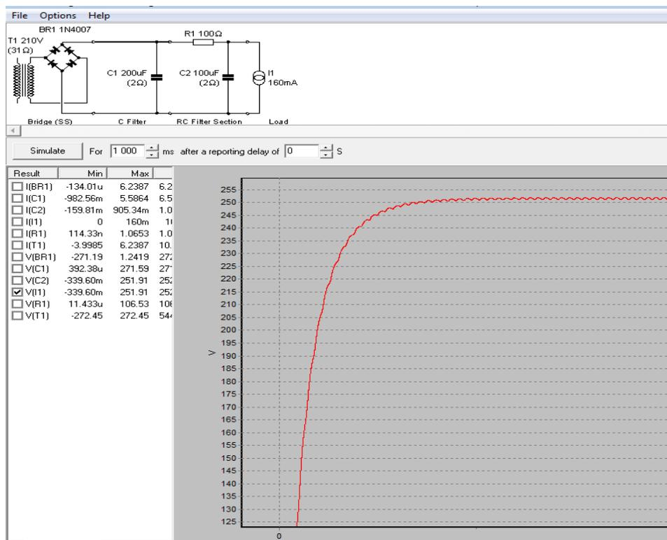
Le filtrage étant simple, il reste une résiduelle alternative (inférieure à 1V) qui ne présente aucun souci pour un montage PP (cf les avantages de ce montage en 2.1):
