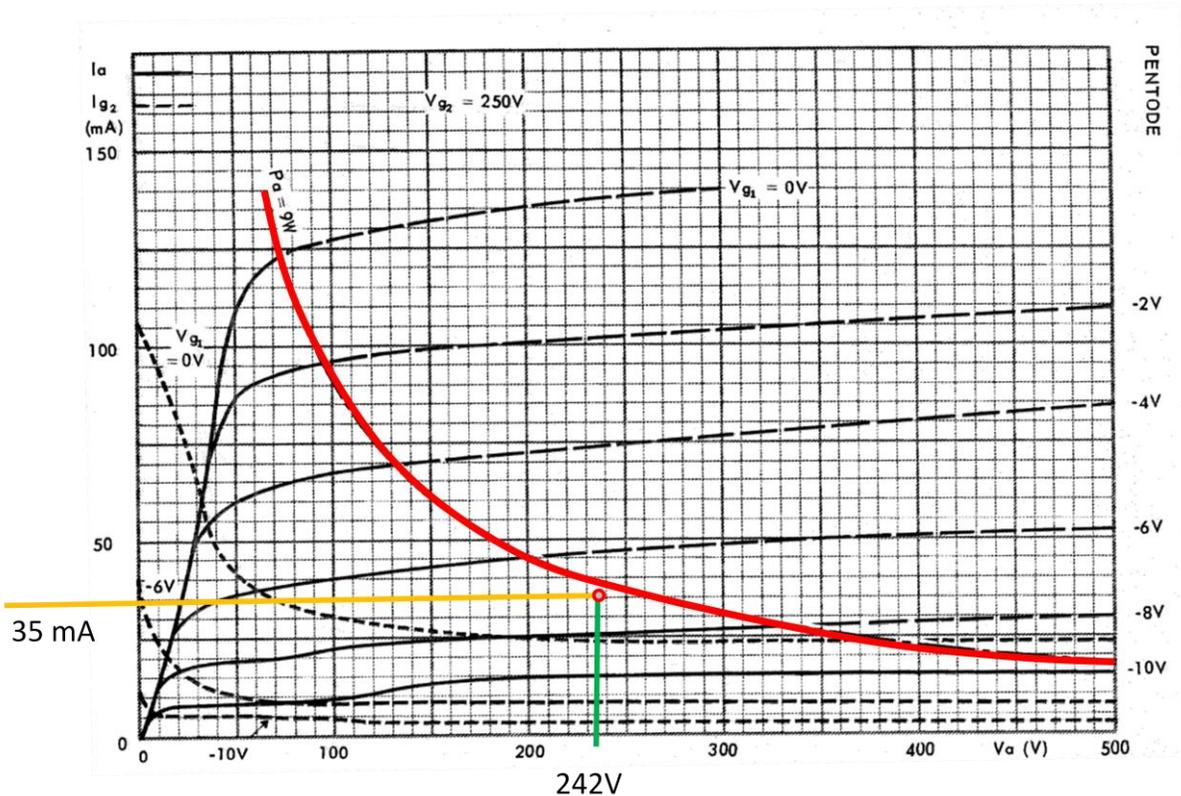
Ce point correspond à une **polarisation Grille** entre -6V et -8V, soit les -7V recommandés par le constructeur. Yves indique -6.6V, probablement la valeur la plus proche obtenue par son diviseur de tension (cf ci-dessous le § 4.3).
