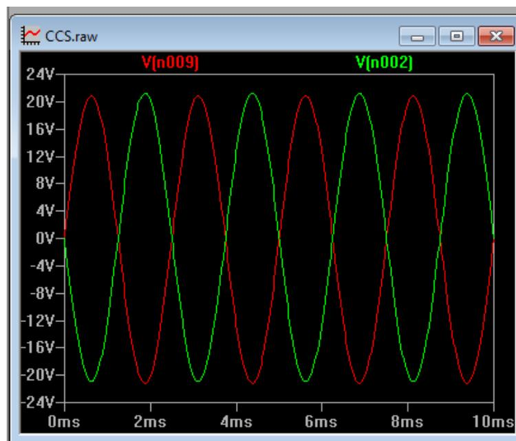
20V, c'est nettement plus qu'il n'en faut en entrée de l'étage de sortie (qui a besoin de'un « swing » de +/- 6V).
