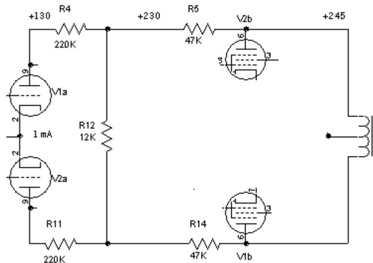
En **régime statique** (en l'absence de signal), et dans un monde idéal, R12 n'est parcouru par aucun courant car les tensions à ses bornes sont identiques.
