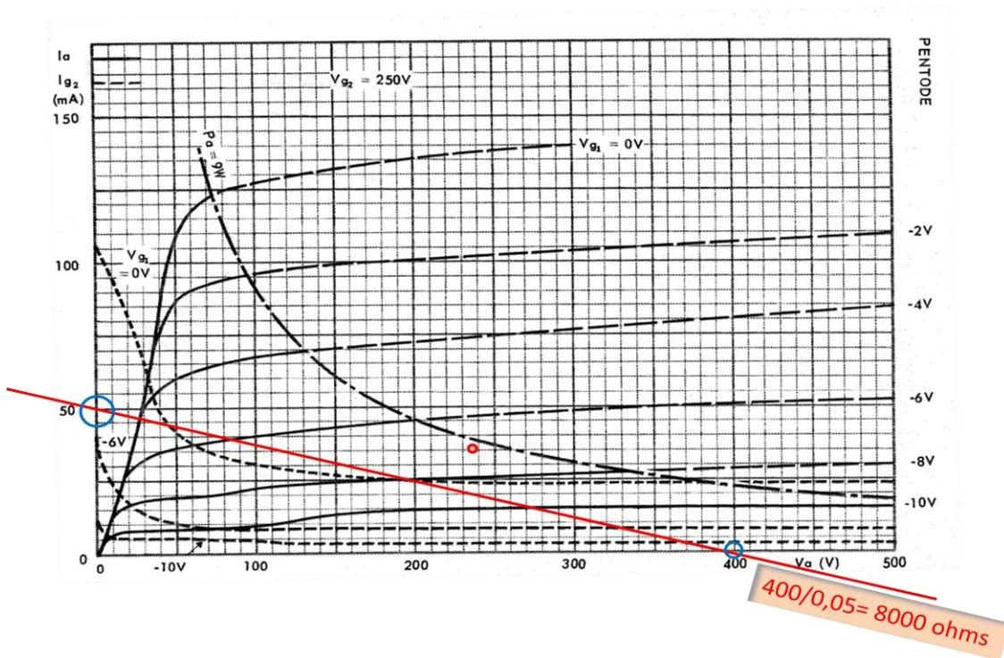
La pente de la courbe étant définie grâce aux points 400V et 50mA ( $400/0,5 = 8000$ ), nous pouvons la déplacer (sans changer d'inclinaison), ce sera toujours la droite de charge pour 8000 ohms.
