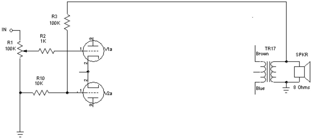
R3 et R10 constituent un diviseur de tension qui renvoie sur le grille de V2a 10/110èmes de la tension de sortie.
